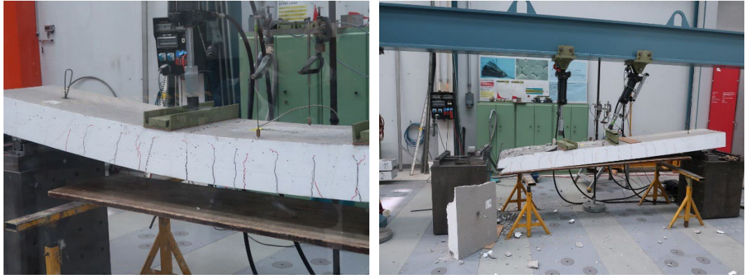
Abb. 7.60 Links: Platte 5 während des statischen Bruchversuches, kurz vor dem Bruch. Rechts: Kurz nach dem Bruch.
