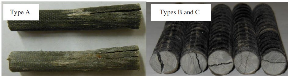
Abb. 4.11 Ermittlung der interlaminaeren Schubfestigkeit mit der "Short beam" Prüfmethode aus [34].
