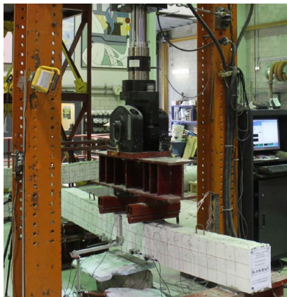
Abb. 4.28 Links: Versuchseinrichtung zur Prüfung der verschiedenen Biegebalken. Rechts: Diagramm des aufgebracht Biegemomentes und die gemessenen Durchbiegungen der Versuche. Foto und Diagramm aus [50].
