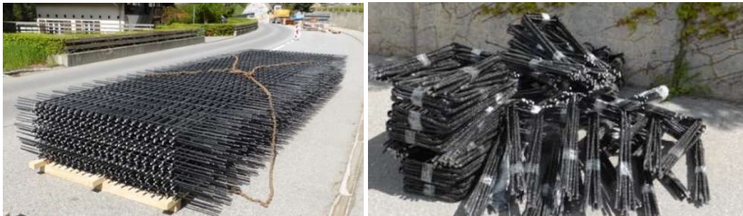
Abb. 3.8 Links: Basaltfaser-Bewehrungsnetze liegen für den Einsatz bereit. Rechts: Basaltfaserbügel. Fotos von Basalt Fibertec GmbH.
