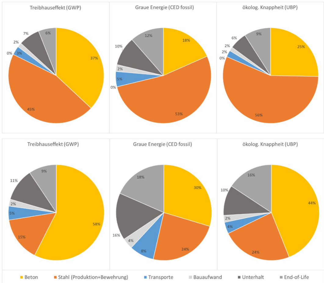
Abb. 9.13 Aufteilung der Umweltbelastung von einer Tunnelzwischendecke mit einer Stahlbewehrung auf die verschiedenen Lebensabschnitte und Materialien. Das obere Bild zeigt die Resultate mit dem Datensatz für "Stahl (high)" – das untere Bild zeigt die Verhältnisse bei der Benutzung des Datensatzes für "Stahl (low)".
