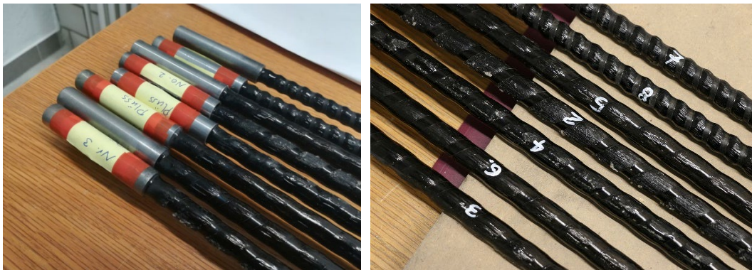
Abb. 7.1 Links: Basaltfaser-Bewehrungsstäbe mit Endverankerung für die Einspannung in der Zugprüfmaschine. Rechts: Grossaufnahme der Stäbe mit Nummerierung und Rippenbild. Der Unterschied des Rippenbildes zwischen der von [96] hergestellten Stäbe (Nr. 1 bis 6) und der aus China importieren Stäbe (Nr. 7 und 8) ist sichtbar.
