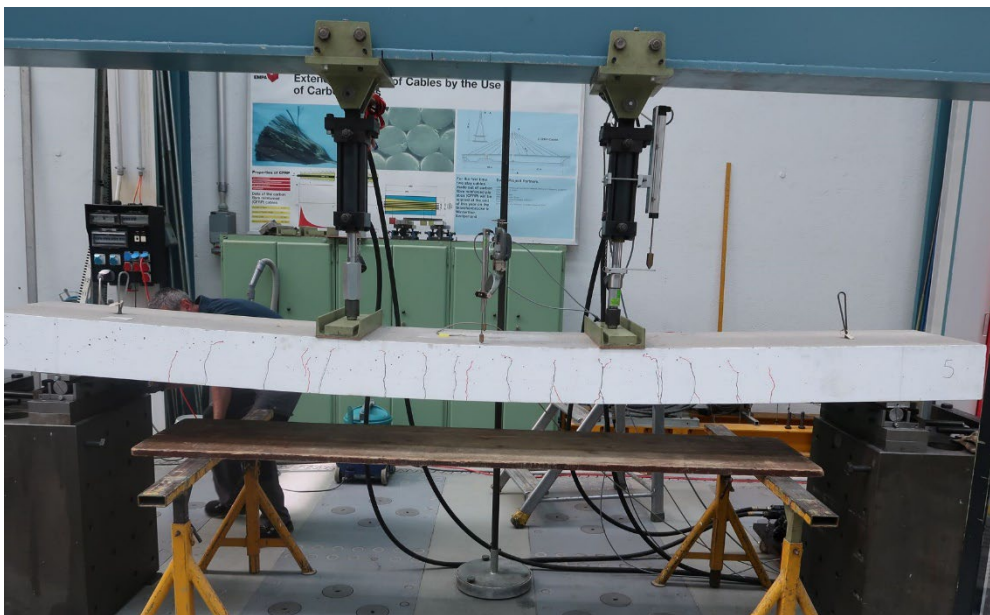
Abb. 7.59 Frontansicht Platte 5 während des statischen Bruchversuches.
